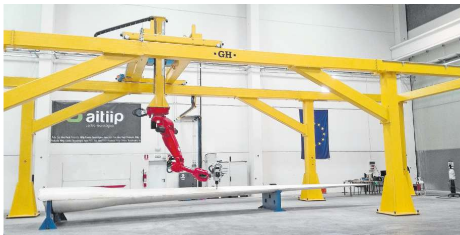
Der Prototyp des Roboters «Kraken», hier im spanischen Saragossa, arbeitet am Rotorblatt einer Windturbine.
